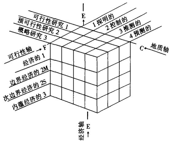
图1 固体矿产资源/储量分类框架图
