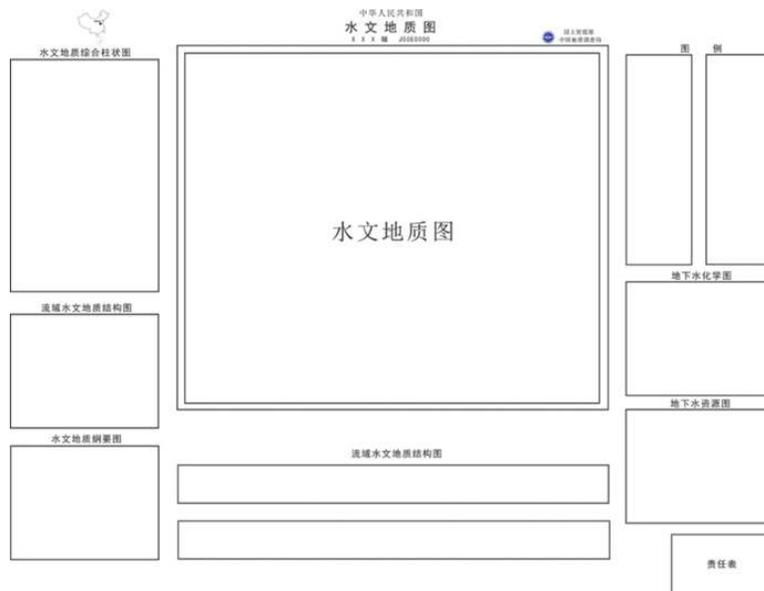
图 1 水文地质图图面结构示意图
